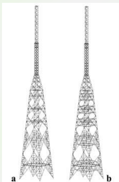
شکل ۸: a دکل قبل از اعمال سیستم مهاربندی و b دکل بعد از اعمال سیستم مهاربندی کمانش اعضا سازه قبل (a) و بعد (b) از بارگذاری در شکل زیر نشان داده شده است:
